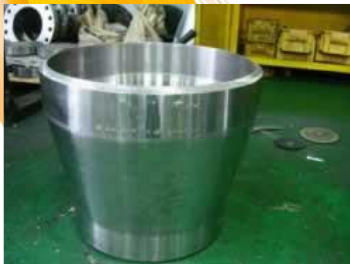
Переход высокого давления
