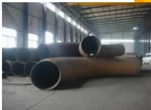
Отвод сваркой встык
