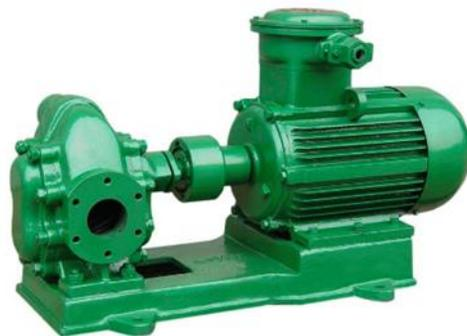
Насос сконструирован надлежащим образом с канавкой для утечки и возврата масла, благодаря чему шестерни выдерживают наименьшее усилие крутящего момента, что обеспечивает отличную защиту подшипников для повышения эффективности насоса.
